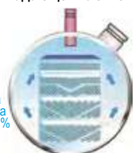
Испаритель со сплошной падающей пленкой
